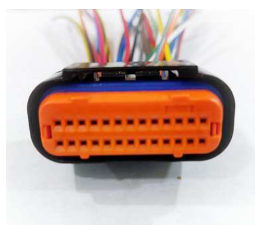
Conector de chasis de 26 pines impermeable portahembra compañero de CA354
