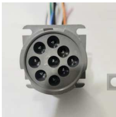
Conector deutsch 9 pin diagnostico obd2 maquinaria, varios hyundai compañero de CA429
