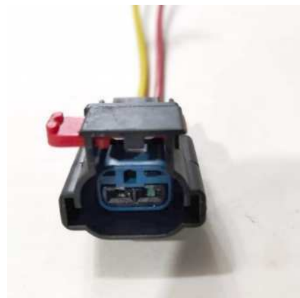
Conector motoventilador y pera de aceite
